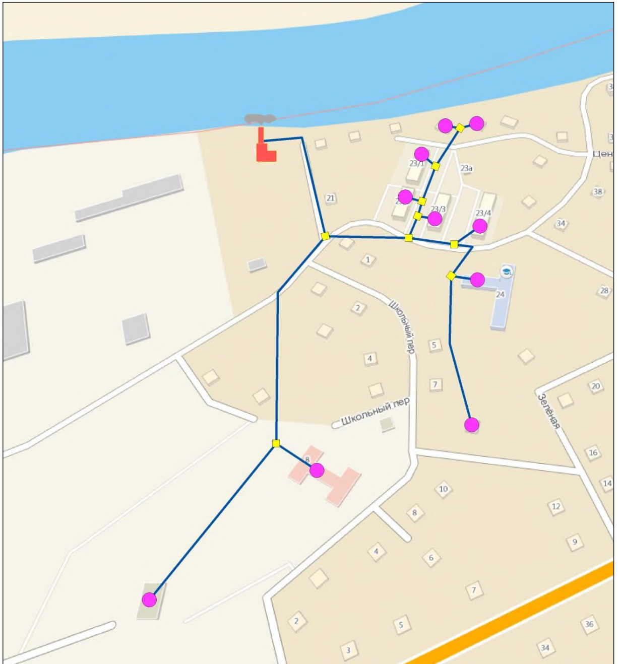
Рисунок 4 – Зона действия котельной в с. Соузга
